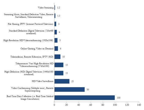
Abbildung 2: Bandbreitenbedarf der anspruchsvollsten Dienste in Mbps. Quelle: Eigene Zusammenstellung aus diversen öffentlich zugänglichen Quellen im Internet.
